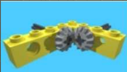
TRANSMISIÓN ENTRE EJES QUE SE CORTAN
