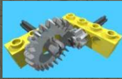
TRANSMISIÓN ENTRE EJES QUE SE CORTAN
